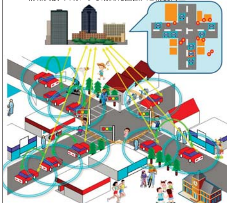
複数センサノードとクラウドを併用した協調型移動物体追跡システムの構成
